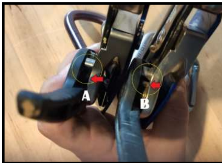
A: STOP 2 DAÑADO / B: STOP 2 OPERATIVO
