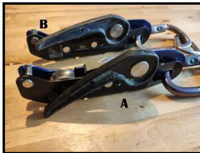
A: STOP 2 DAÑADO / B: STOP 2 OPERATIVO
